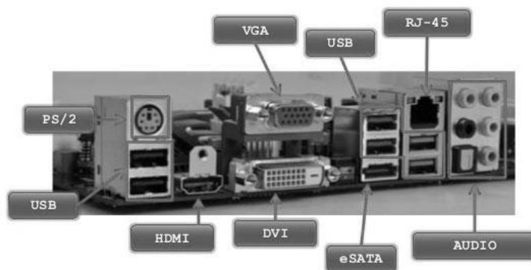
Actualmente los puertos que se pueden usar son: USB (bus de serie universal sirve para cualquier elemento del ordenador), PS/2 (para el ratón y teclado son de color verde y violeta), VGA (para el monitor), Firewire (para distintos elementos), ...
